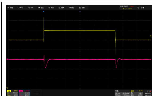
图 19. CL=1\mu\text{F} 线性动态响应
